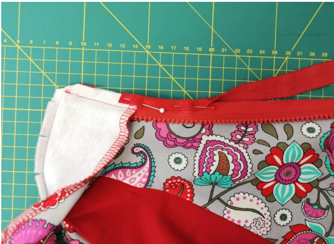
12. Přední kraj s našitou zipovou tkanicí olemujeme lemovací pruženkou. Začínáme cca 2cm nad našitím stojáčkem.
